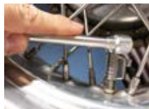
バルブに押し込むだけで自動で ホールドされるオートエアチャック
