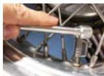
バルブに押し込むだけで自動で ホールドされるオートエアチャック
