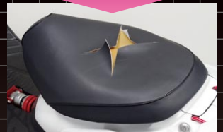
①シート生地が破れた状態。
