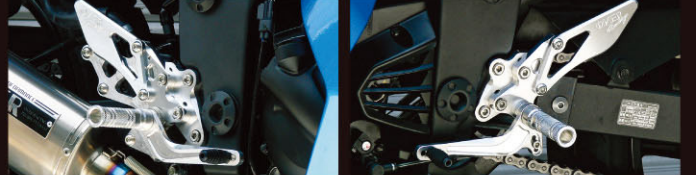
ペダル稼働部にベリングを採用しスムーズなシフトタッチと、レースからストリートまで対応したポジションングが選択可能です。
